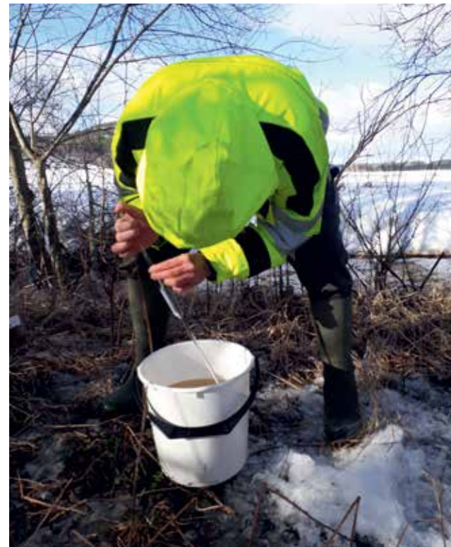
Vid både Färgeriån och Styvjebacken har under vårvintern gjorts precisa mätningar av den momentana vattenföringen med saltutspädningsmetoden i samband med vattenprovtagning.
