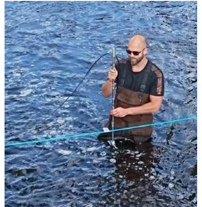
Daniel Rickström gör en kalibreringsmätning av vattenförmingen med en stångflygel i Söderhamnsån.
