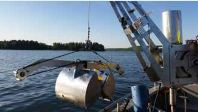
Bild på en Van Veen huggare. En liknande huggare användes vid provtagningen av bottenfauna i kustvattnet.
