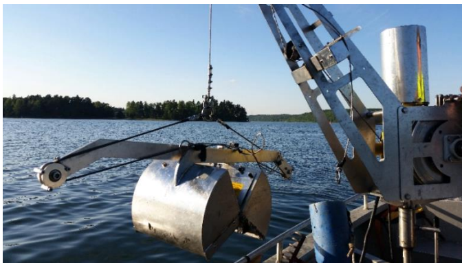
Figur 2. Bild på en van Veen huggare. En liknande huggare användes vid provtagningen i kustvattnet i Ljusnan- Voxnans avrinningsområde.
