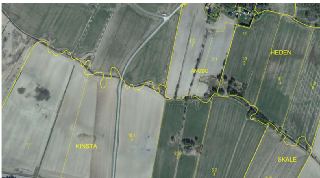
Figur 31. Söderhamnsån norr om väg 50 vid Kinsta. Vattendragets planform är förändrad genom rätning och kanalisering medan fastighetsgränserna fortfarande följer den gamla, ursprungliga planformen.
