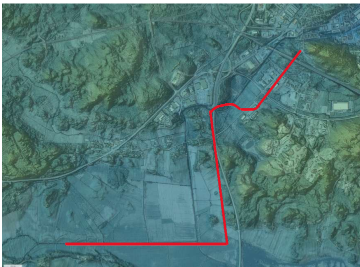
Figur 9. Höjddata över Söderhamnsåns nedre delar där det tydligt framkommer hur rätad och kanaliserad ån är i sitt nedre lopp. Ån är framhävd genom röd markering.
