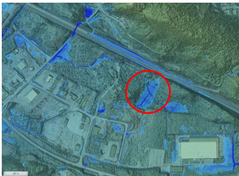
Figur 26. Föreslagen placering av dagvattendamm (markerad med röd ring) i redan befintlig sänka i terrängen.
