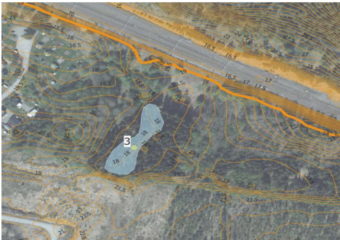
Figur 27. Förslag på placering av dagvattendamm i befintlig sänka uppströms koloniområdet. Tillkommande slänter är inte medtagna i figuren. Bilden är tagen från WRS rapport och siffran anger åtgärdsplats 3 i rapporten.
