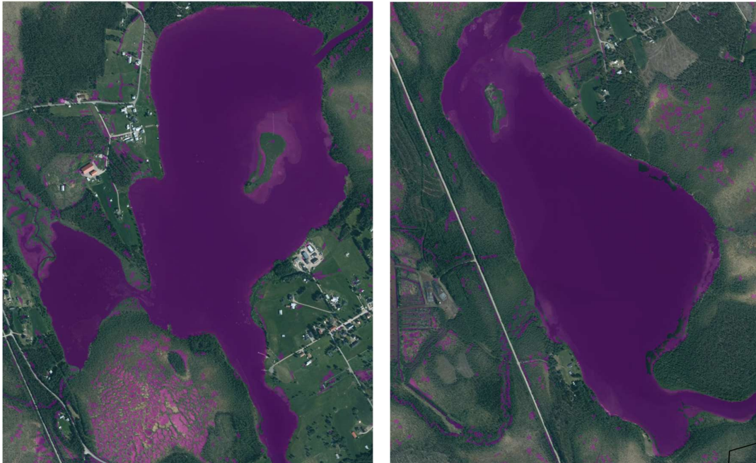
Figur 9. Modellerad vattennivåhöjning i Håsjön och Håttjärnen (vänster) och Yttersjön (höger) motsvarande 3 dm i Veman, vid Yttersjöns utlopp. Vattennivån är illustrerad med ett transparent lila lager i kartan, som är konstruerad i Scalgo Live.
