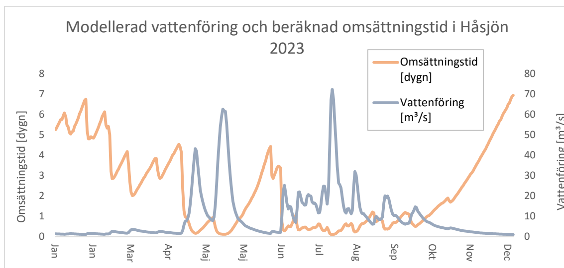
Figur 5. Modellerad vattenföring och beräknad omsättningstid i Håsjön under 2023. Vattenföringen i \text{m}^3/\text{s} visas med blå linje och omsättningstiden i dygn med orange linje.
