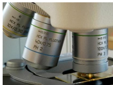
Figur 1. Kiselalgsskalen prepareras fram och fixeras på objektglas. Analys görs i ljusmikroskop i 1000 gångers förstoring med oljeimmersionsobjektiv. Mikroskopet ska helst vara utrustat med interferenskontrast, vilket gör att man kan se mycket små former tydligare än med andra tekniker.
