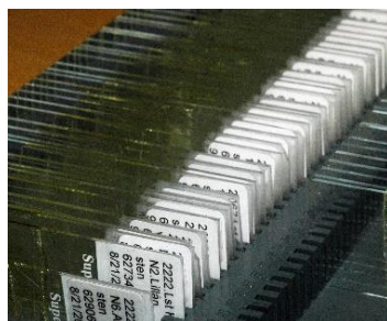
Figur 1. Kiselalgsskalen prepareras fram och fixeras på objektglas. Analys görs i ljusmikroskop i 1000 gångers förstoring med oljeimmersionsobjektiv. Mikroskopet ska helst vara utrustat med interferenskontrast, vilket gör att man kan se mycket små former tydligare än med andra tekniker.
